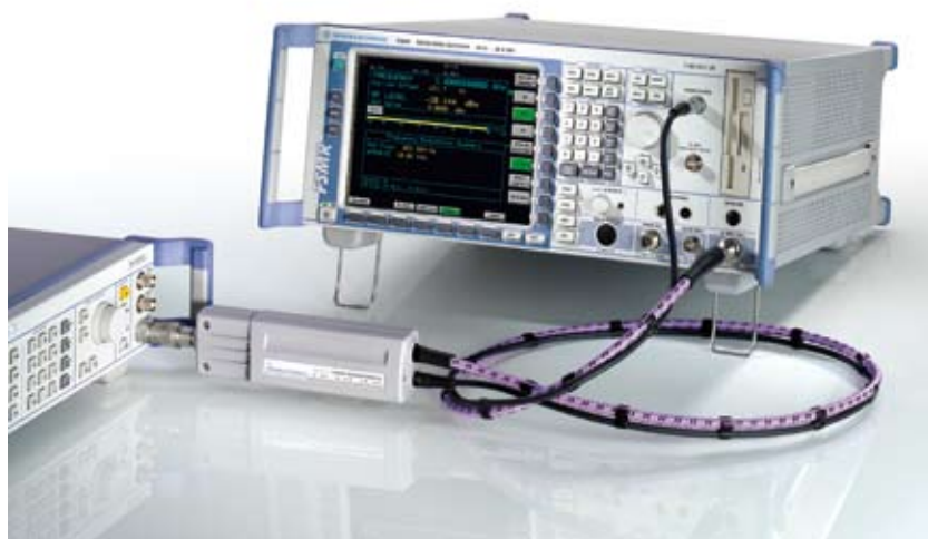
R&S®FSMR mit dem Leistungsmessmodul R&S®NRP-Z27
